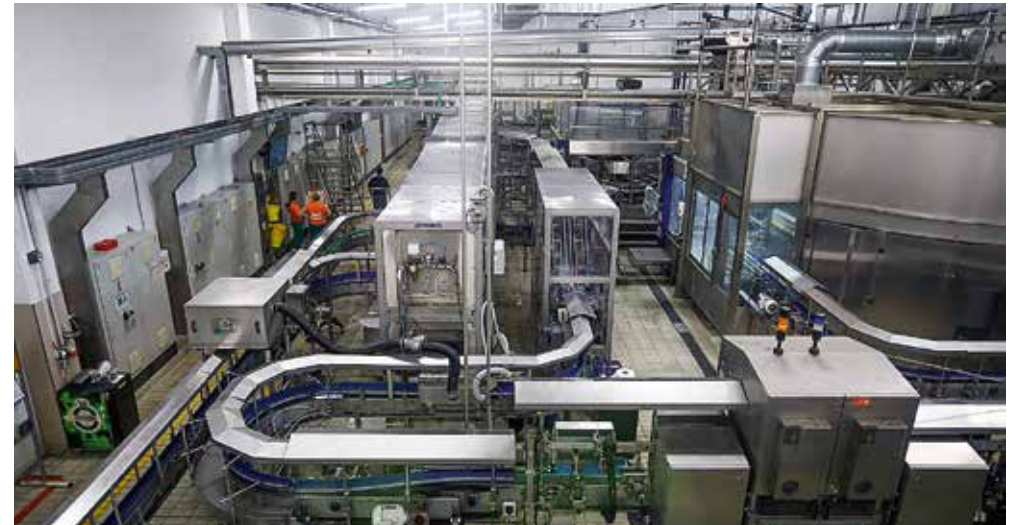
Instalacijom uređaja za ispiranje nepovratnih boca smanjit ćemo potrošnju vode za 2.800 m 3 godišnje, električnu energiju za 185.000 kWh te toplinsku energiju za 260.000 kWh.
